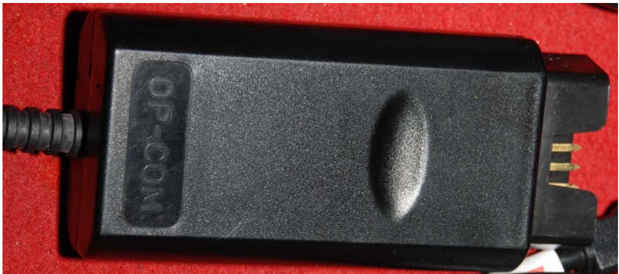
Rückseite mit OP-COM Prägung links keine USB-Steckdose, sondern feste Verkabelung mit USB-Stecker, welcher direkt an den PC angeschlossen wird.
