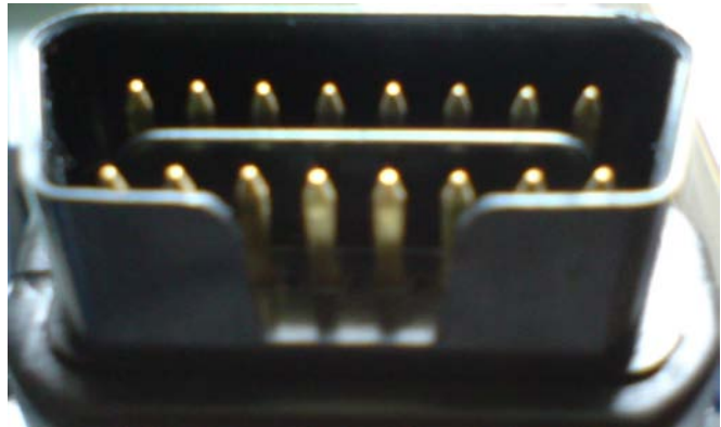
OP-COM OBD-II Interface Anschluss. Rechts Original (Vergoldete Stifte)
