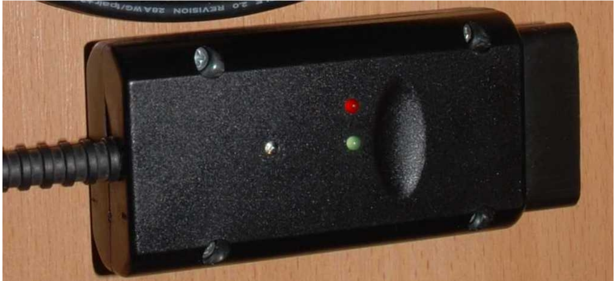
Vorderseite mit 3 LED's Rot, Grün und Weiß, Merkmal die Anordnung der LED's
