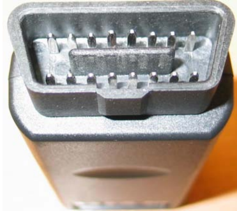
OBD-II Interface Anschluss. Links Fälschung
